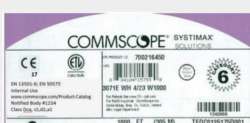
Le règlement des produits de construction (CPR) impose que la marque CE et la classe de résistance au feu soient imprimées sur l'étiquette du produit. L'impression n'est pas obligatoire sur le câble.
