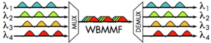
Figura 22. Multiplexión de división de longitud de onda a través de MMF de banda ancha
