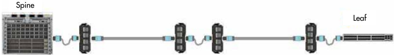
Figura 7. Leaf-spine con enlace de fibra paralela y DA intermedio
