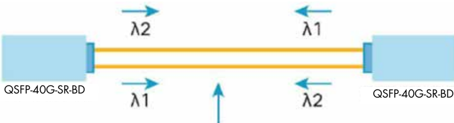
Fibra multimodo dúplex con conectores LC en ambos extremos
