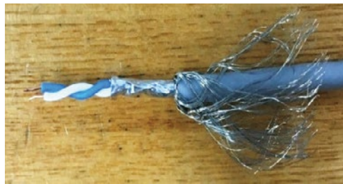
Figura 2: Ejemplo de cableado blindado de tipo IEC 61156-11
