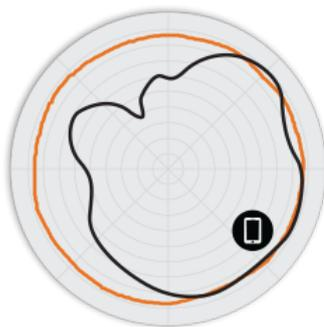
FIGURA 3 R610 5 GHz: patrones de antena en acimut
