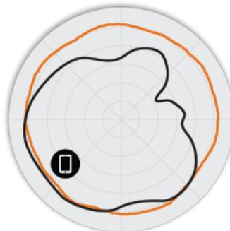
FIGURA 4 R610 2,4 GHz: patrones de antena en elevación
