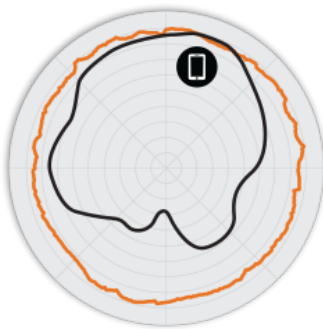
FIGURA 2 R720 2,4 GHz: patrones de antena en acimut
