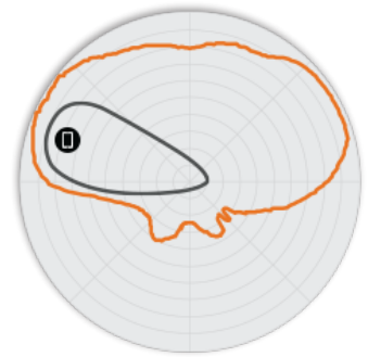
FIGURA 5 R720 5 GHz: patrones de antena en elevación
