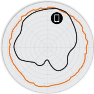
Figura 3. T750 5 GHz: patrones de antena en acimut
