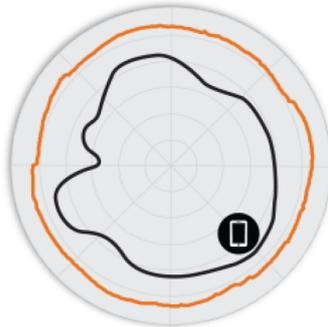
Figura 4. T750 2,4 GHz: patrones de antena en elevación
